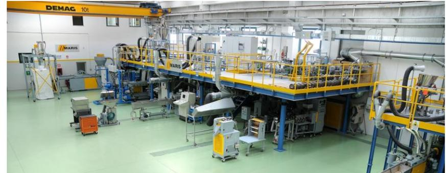
Quatre lignes d'extrusion équipées avec accessoires et équipements périphériques.
